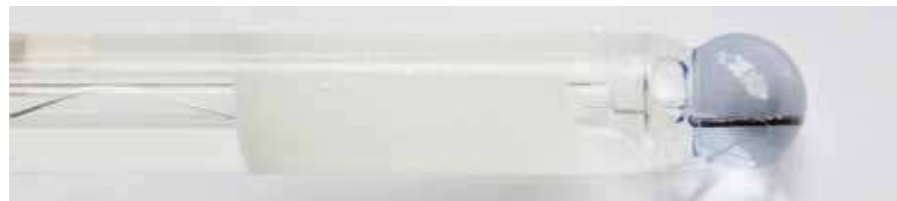
3 Blaue pH-Glaskugel an der Spitze einer pH-Elektrode.
