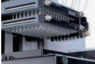
384及96孔板清洗，BioTek专利的Dual-Action 192道及96道洗头，可独立控制抽吸功能，精准完成洗板操作
