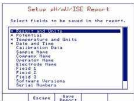
自定义选择报告信息模式，保存每个测量数据的操作信息和校准信息，做到量值溯源
