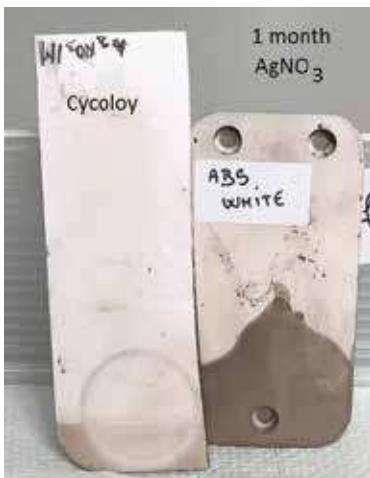
更耐用的 Cycoloy 材质，抗化学腐蚀
