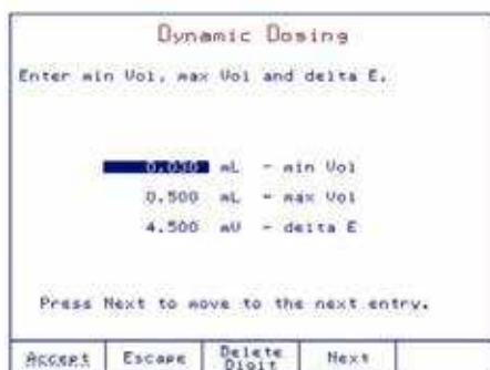
可根据反应类型选择线性体积滴定或者动态体积滴定，设置体积滴加参数，提高精度
