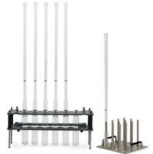
化学需氧量 (使用空气回流冷凝器)
