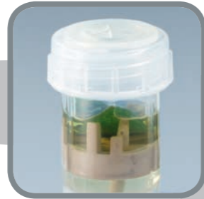
第二步 将薄荷叶碎片与乙醇混合放入DT定-转子分散管中。
