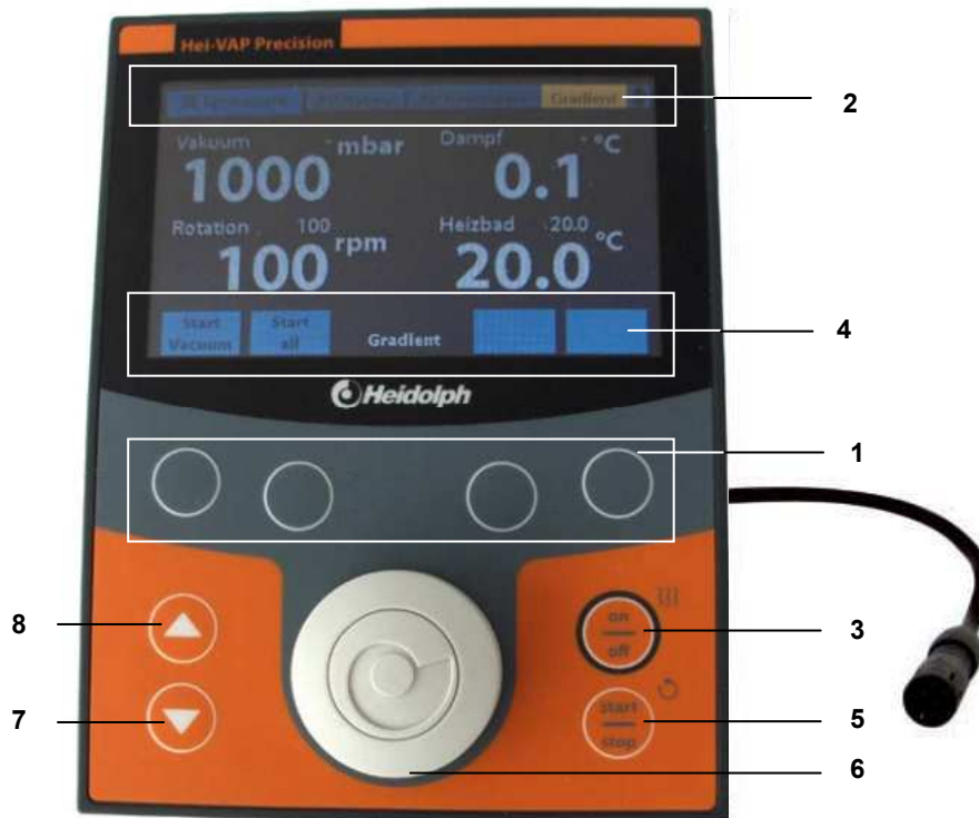
Figura 39-1: Quadro di comando apparecchio base / bagno di riscaldamento / visualizzazione valore effettivo
